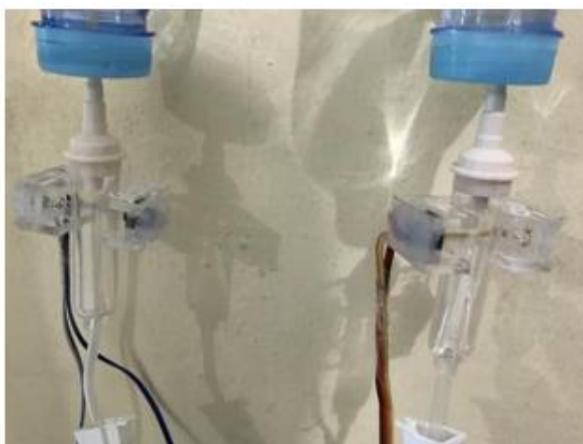
Gambar 4.2 Sensor Pendeteksi Tetesan
